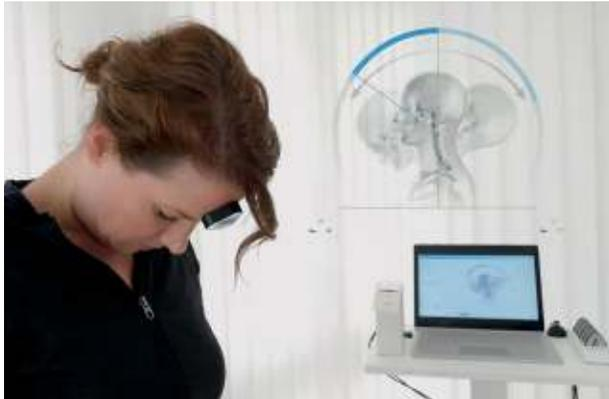
iEMG Sensoren ermöglichen die Untersuchung und Therapie der elektrischen Muskelaktivität durch Oberflächen-EMG Messungen und Biofeedback. Erkenntnisse über Muskel-Dysbalancen sind auf einen Blick sichtbar und Biofeedback-Training hilft bei gezielter Muskelansteuerung nach Verletzungen oder Operationen. Durch die integrierte Inertial-Messtechnik ist die genaue Aufzeichnung und Darstellung von Bewegungsabläufen im dreidimensionalen Raum möglich.
